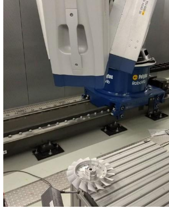
Şekil 1: 240 mm çapında bir disk üzerinde 3D Tarama Lazer Doppler Vibrometrenin ölçüm kurulumu
